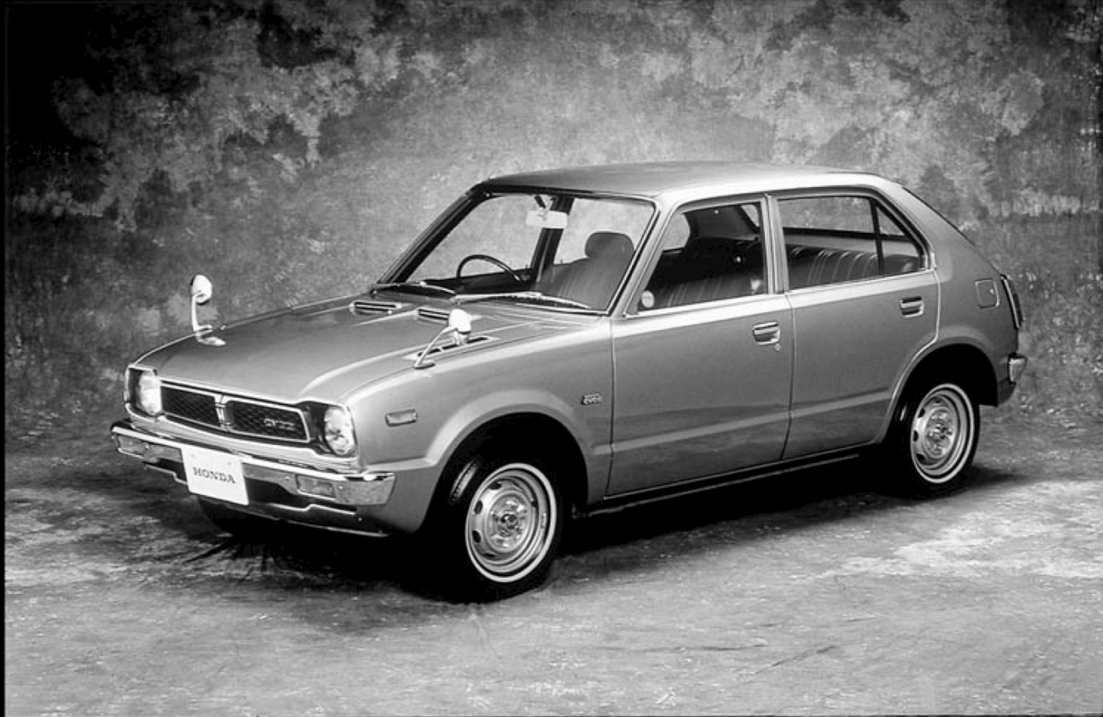
CIVIC CVCCエンジン 当時遵守するのが難しいと言われたマスキー法をクリア 1970年代最優秀技術車 (AUTOMOTIVE ENGINEERING)
