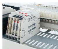
銅バー部に内蔵された電流センサ
