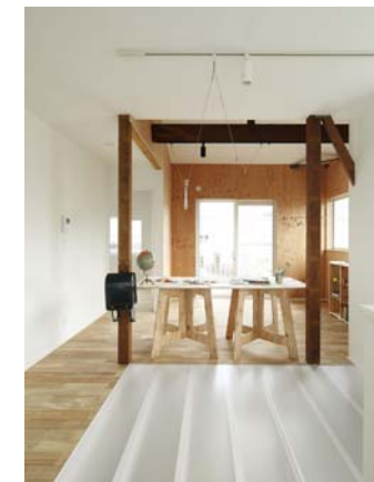
●2014年度実績-みたけ台の住宅-2階子供部屋。手前は1階に光を落とす半透明の床(株)リビタ
